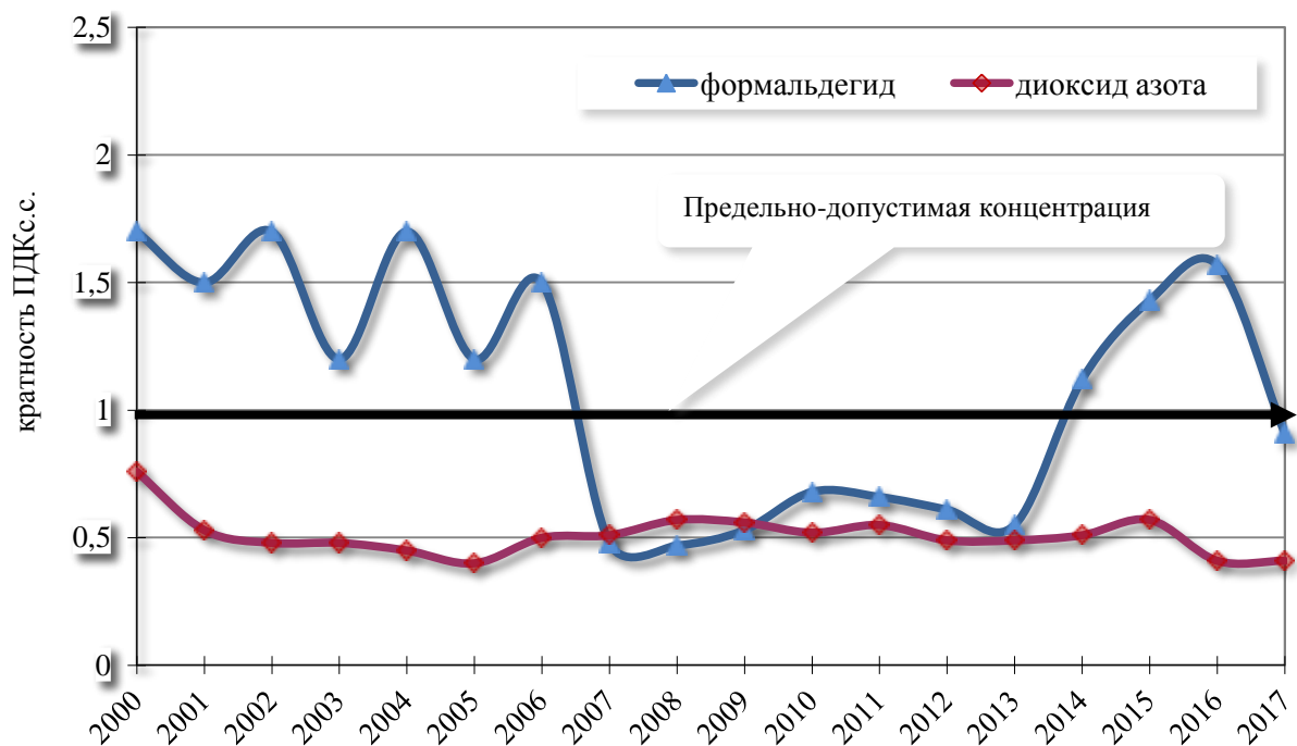
Рисунок 40 – Динамика загрязнения атмосферного воздуха г. Могилева формальдегидом, азота диоксидом (в кратностях ПДКс.с.) в 2000-2017гг.
